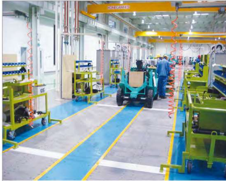
链板式地面车辆装配输送线
