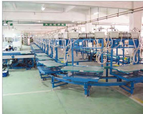
空调循环小车线
